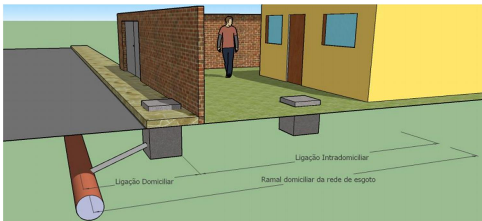
Figura - Esquema da ligação domiciliar de esgoto
